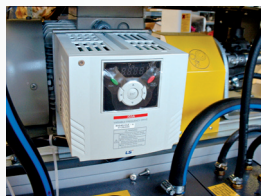
BI8202009 Verzia "Inverter" s plynulým nastavením otáčok čerpadla v skúške od 200/1500 c.a.
